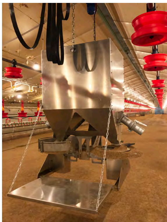
Figure 9 : Cette pailleuse permet de repailler sous forme de pellets, tout en limitant les risques de biosécurité, étant fixe dans le bâtiment
